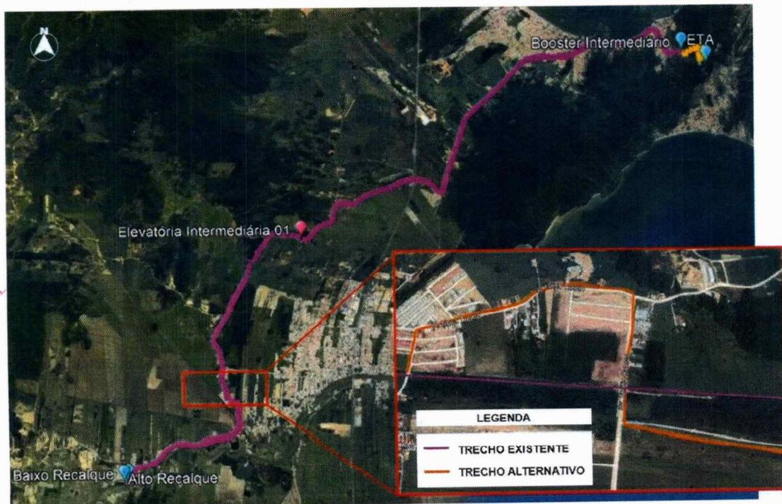
**Figura 3: Alteração de traçado e/ou material da adutora**
